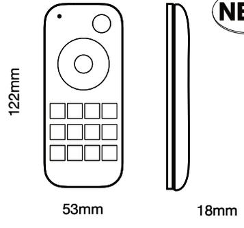
Telecomando 2.4Ghz quadri canale con ghiera touch per la regolazione dell'intensità di luce, cambio colori, 4 scenari programmabili, funzione fade.
