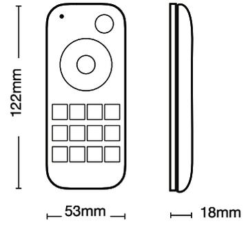
Telecomando 2.4Ghz mono canale con ghiera touch per la regolazione dell'intensità di luce, cambio colori, 4 scenari programmabili, funzione fade.
