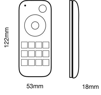
Telecomando 2.4Ghz a 4 canali con ghiera touch per la regolazione dell'intensità di luce, 4 scenari programmabili, funzione notturna e timer
